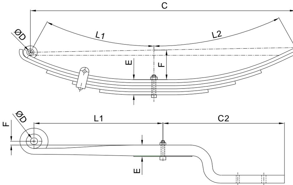
L1 y L2 = Longitudes tomadas desde el eje del ojo (o extremo de la lámina) hasta la abrazadera siguiendo el perfil de la lámina.
