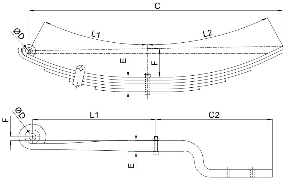
L1 e L2= lunghezze prese dall'asse dell'occhio (o estremità della lama) fino al perno di arresto, seguendo la curvatura della lama.
