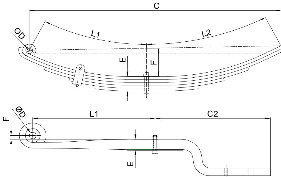
L1 et L2 = Longueurs prises depuis l'axe de l'oeil ( ou extrémité de la lame ) jusqu'à l'étoquieu en suivant le galbe de la lame.
